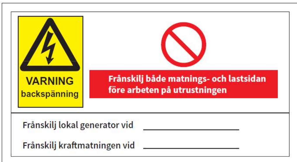
Figur 2. Exempel på varningsskylt.
